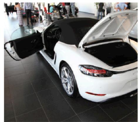
Le moteur étant à l'arrière, sous le capot avant de la 718 se trouve un petit coffre à bagages, comme sur une 911. Mais comme le moteur est très compact, il y en a aussi un second coffre à bagages à l'arrière.
