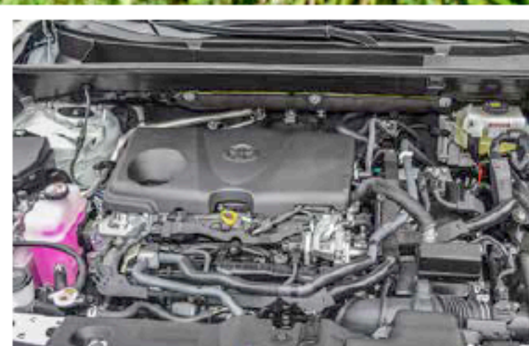
Toyota a décidé d'augmenter la cylindrée du moteur essence de sa motorisation hybride, qui est maintenant un 2,5 litres développant 178 chevaux.
