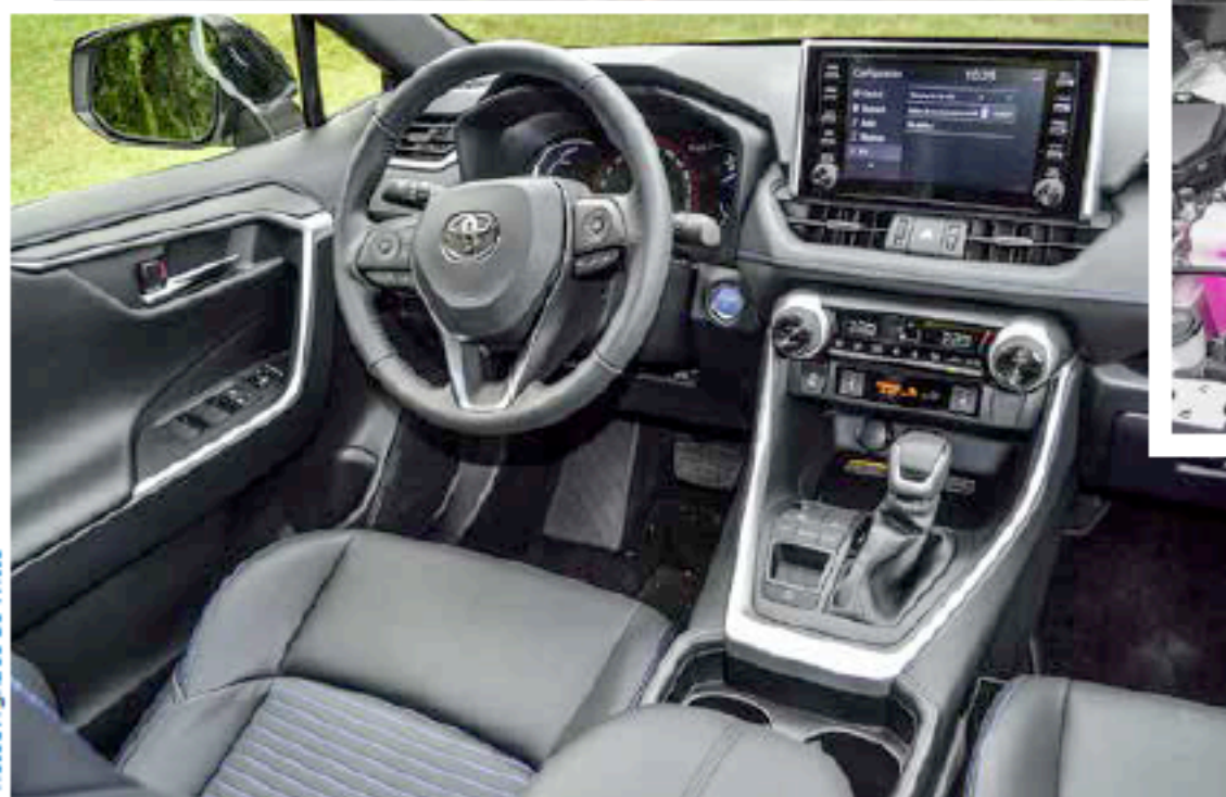
Cachées derrière le volant, les palettes + et - pour monter ou descendre les rapports.
