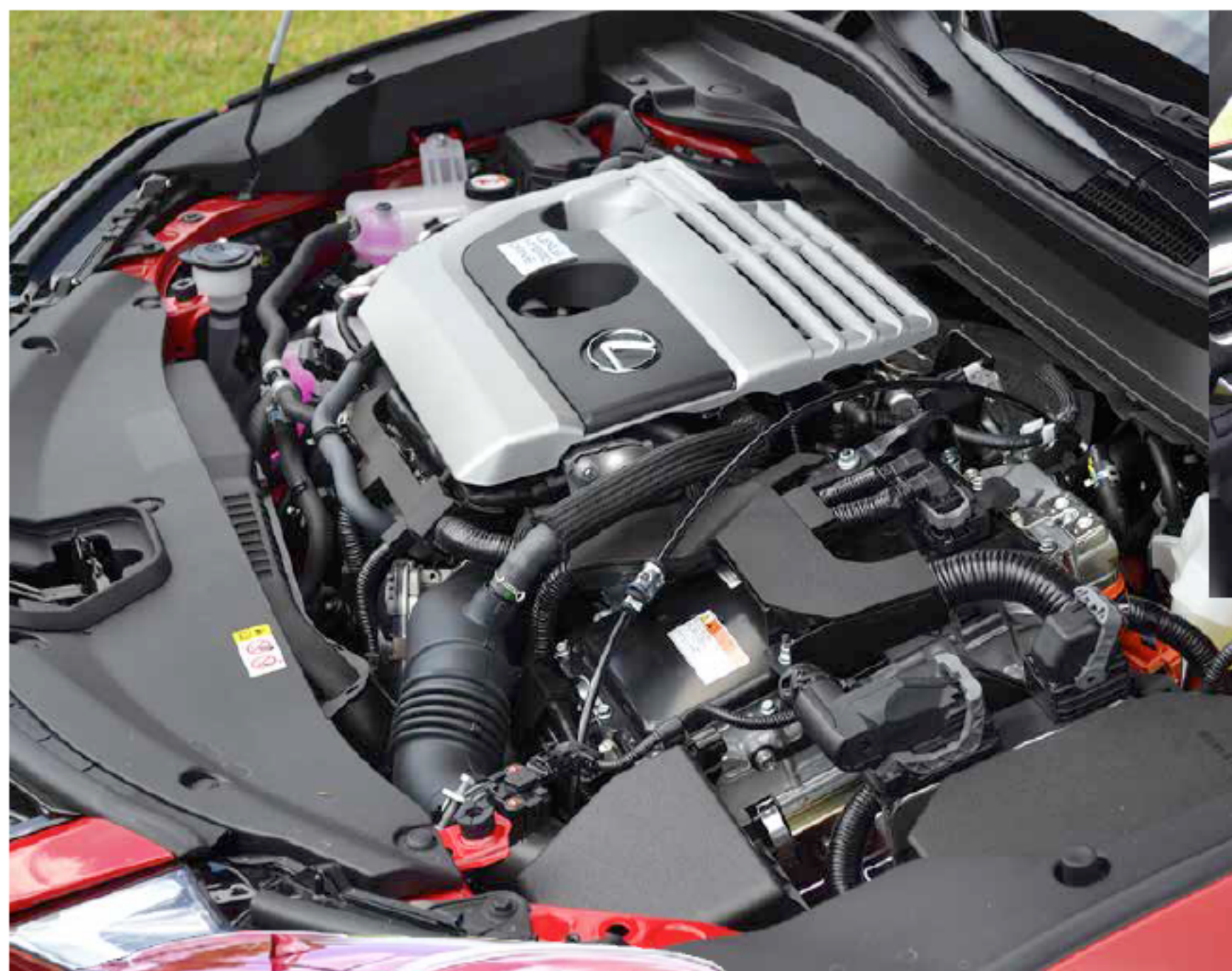
La motorisation hybride de la nouvelle Lexus repose essentiellement sur un gros moteur essence de 2 litres de cylindrée.
