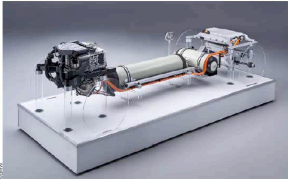
La future BMW i Hydrogen Next a été mise au point en partenariat avec Toyota. À l'avant la pile à combustible qui transforme l'hydrogène en électricité, au centre les deux réservoirs de 60 litres chacun et à l'arrière le moteur électrique avec juste au dessus une petite batterie.
