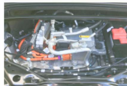
En soulevant le grand cache en plastique, on découvre le 1er moteur électrique, sur le train avant, le 2e étant sur le train arrière.
