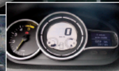
Le coupé Mégane dispose d'un bloc compteur analogique pour le compte-tours et digital pour la vitesse.
